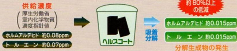
※1(デシケーター法)吸着特性を調べる一般的な試験方法。試験条件は、試料負荷率: 1.0ml/m<sup>3</sup>、各種ガス濃度測定器具: ガステック社製ガス検知器およびガス検知警報器を使用。
